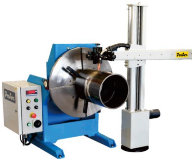
圖示: MP-0606 電動升降式十字臂搭配 PT-450 轉盤(荷重 450 公斤)
